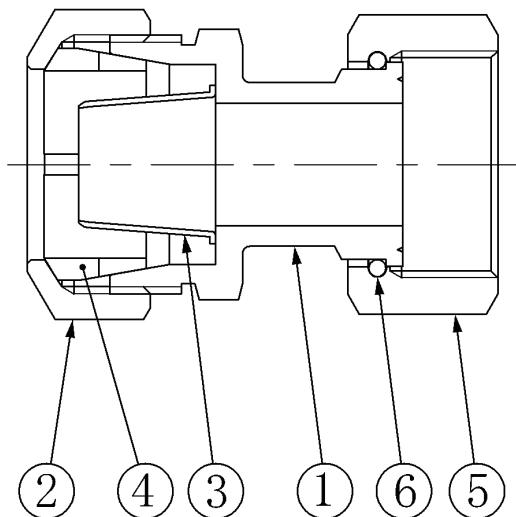
表 A1 – 継手の構造及び形状
