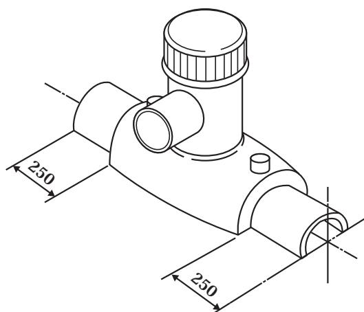
図2－サドル接合部試験片の形状・寸法
