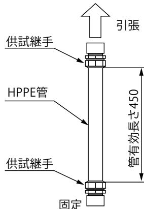
図 A2 – 高速引張試験装置
