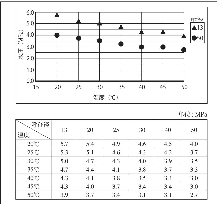
表 16 3種二層管の口径別耐圧強度(破壊圧力)
