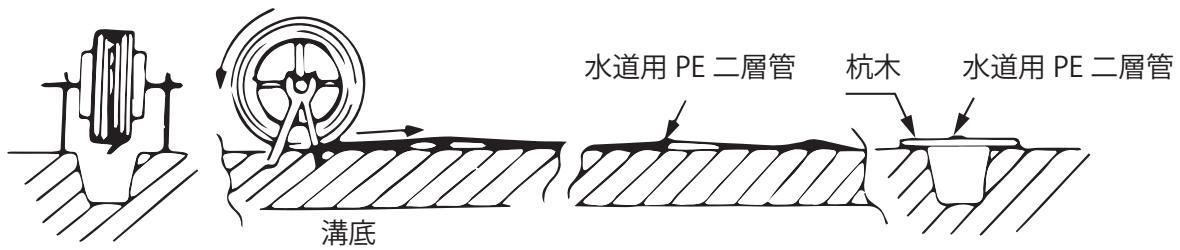
図 32 呼び径 25 以下の長尺配管要領
