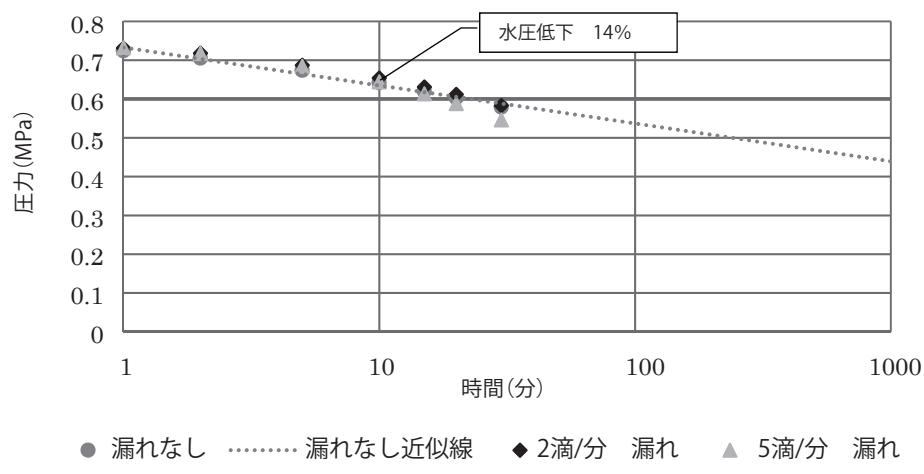
図 19 1種二層管(PE50)呼び径 50
