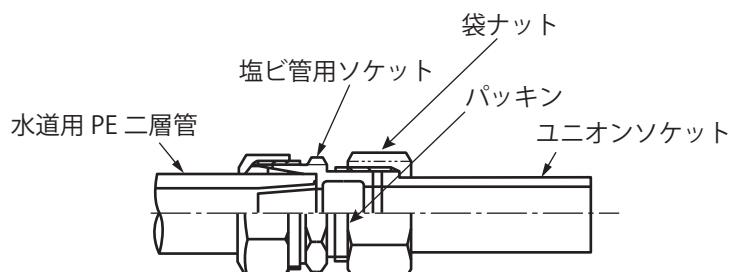
図 21 硬質ポリ塩化ビニル管との接合
