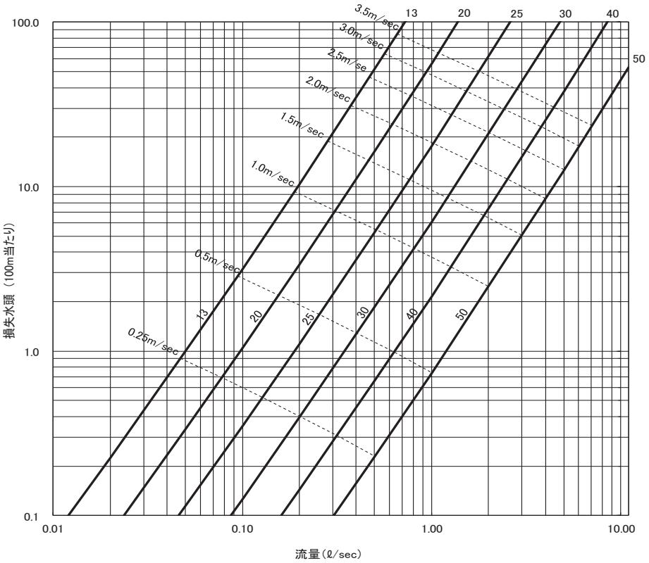
図 10-3 水道用 PE 二層管（3 種二層管）
