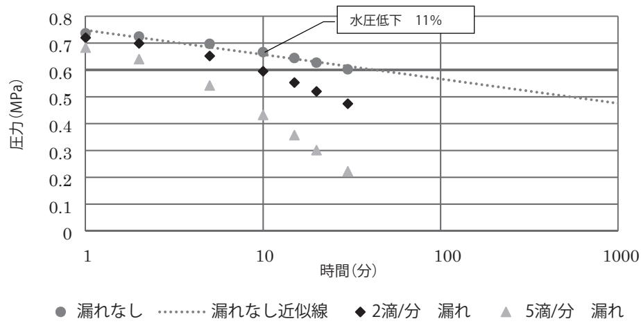
図 20 1種二層管(PE100)呼び径 25
