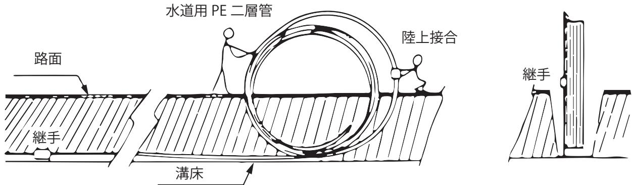
図 33 呼び径 30 以上の長尺配管要領
