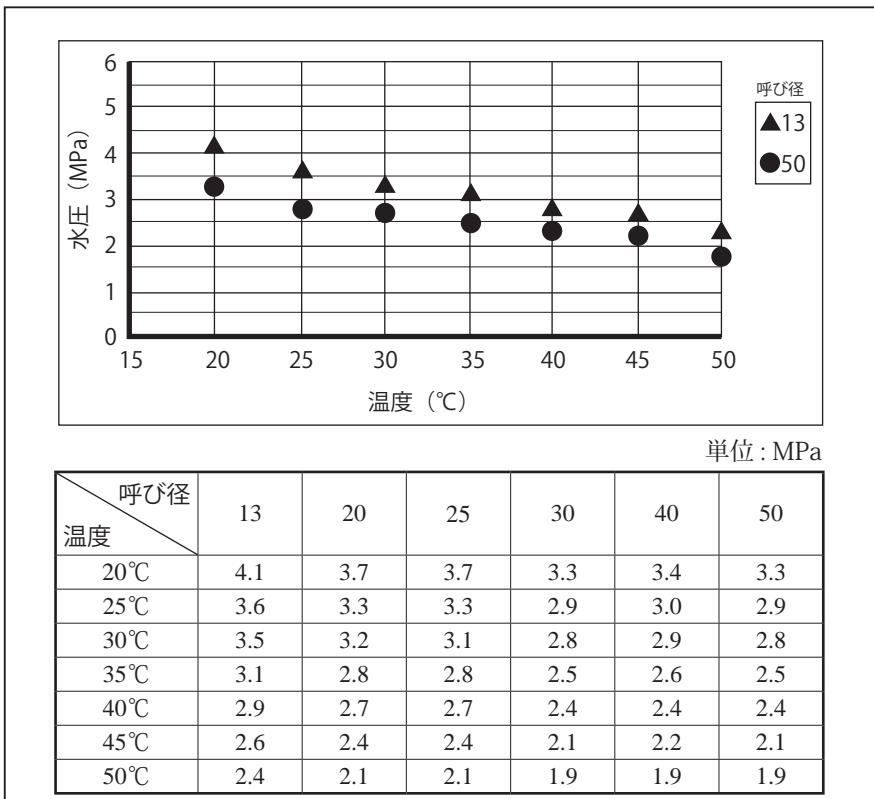
表 14 1種二層管(PE100)の口径別耐圧強度(破壊圧力)
