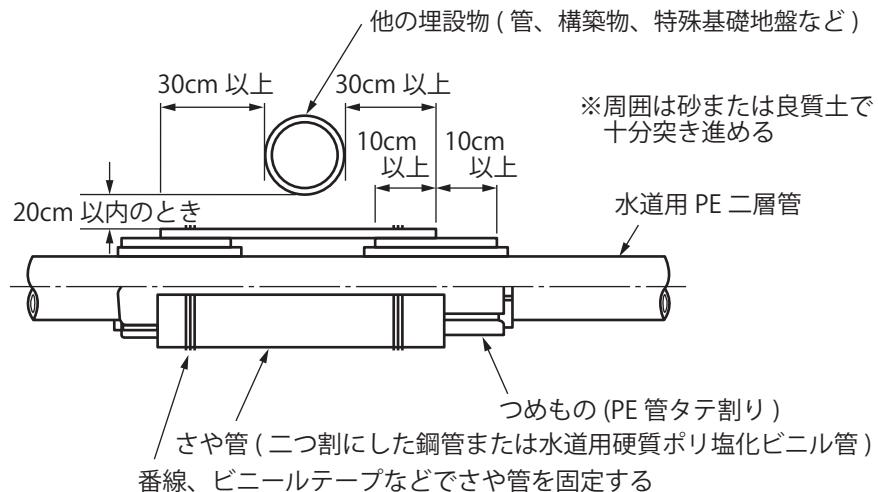
図30 水道用PE二層管保護方法（水道用PE二層管を布設済の場合）
