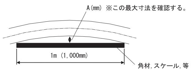
図31 最小曲げ半径の施工管理方法
