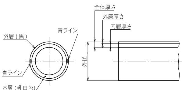
図 1 – 管の構造及び色 (3種二層管公称外径 25 ~ 50)
