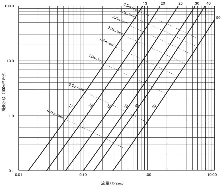
図 10-2 水道用 PE 二層管（2 種二層管）
