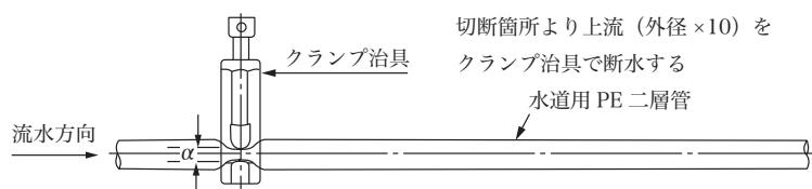
図4 クランプ治具による断水
