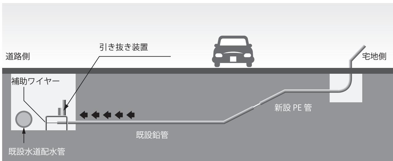
図 24 非開削工法のイメージ
