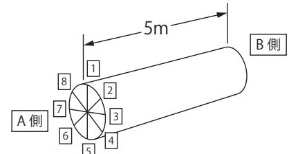
図7 管厚測定個所
