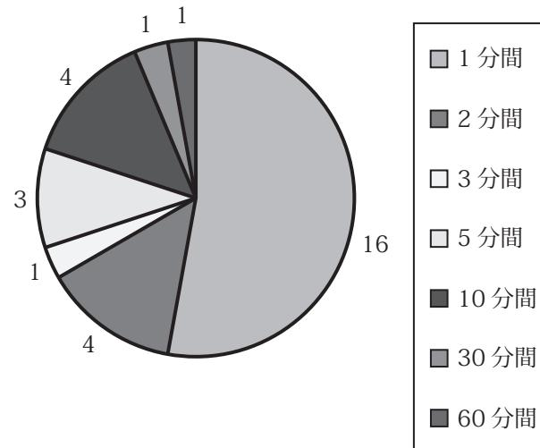
図16 給水装置の水圧試験時間
