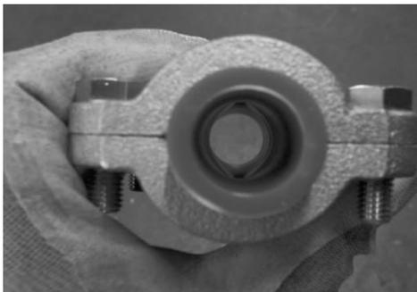
図 21 スクイズ部の管内面写真
