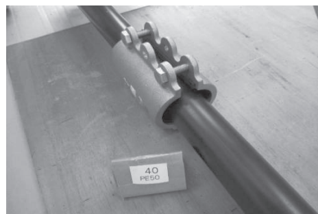
図 16 補修継手の取付確認 (1 種二層管 (PE50) 呼び径 40)
