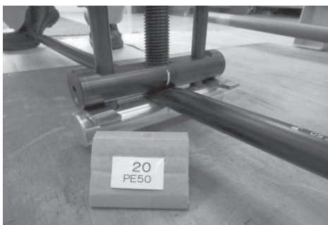
図 15 補修継手の取付確認 (1 種二層管 (PE50) 呼び径 20)
