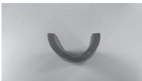
図 30 スクイズ部の断面 全体と拡大 (青色単層管(PE100) 呼び径40)
