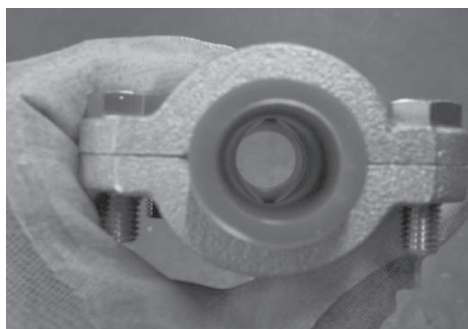
図 21 スクイズ部の管内面写真 (青色単層管(PE100) 呼び径20)
