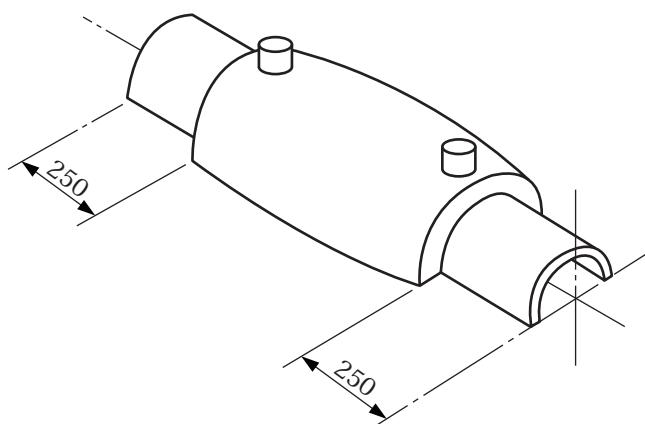
図 1 – 受口接合部試験片の形状・寸法
