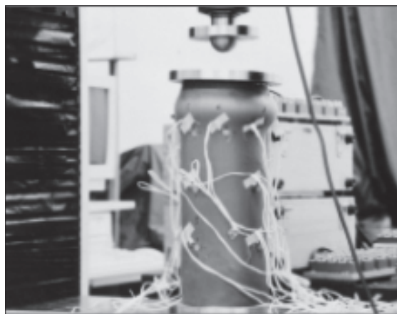
管軸方向圧縮試験の状況（公称外径 180）
