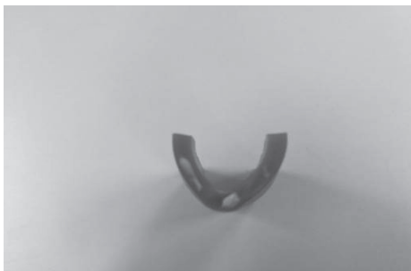
図 24 スクイズ部の断面 全体と拡大（1 種二層管 (PE50) 呼び径 20)
