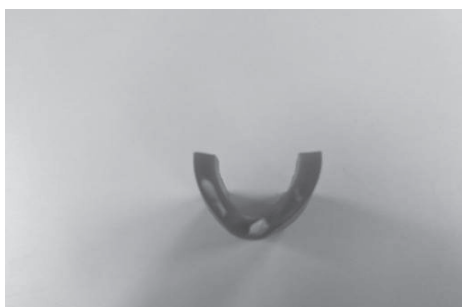
図 28 スクイズ部の断面 全体と拡大 (1種単層管(PE100) 呼び径 20)
