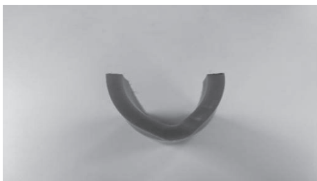
図 26 スクイズ部の断面 全体と拡大（1 種二層管 (PE50) 呼び径 40)
