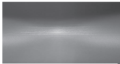
図 25 スクイズ部の内面 全体と拡大（1 種二層管 (PE50) 呼び径 40)
