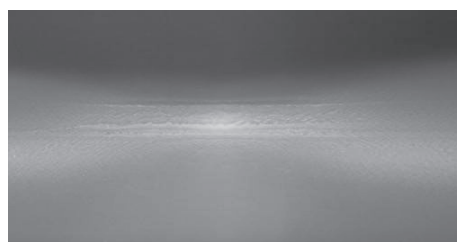
図 29 スクイズ部の内面 全体と拡大 (1種単層管(PE100) 呼び径40)
