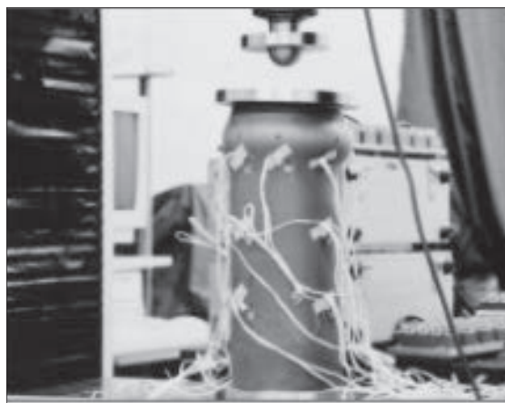
管軸方向圧縮試験の状況（公称外径 180）
