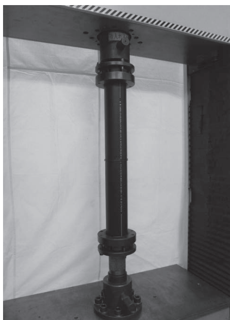
BF 接合部引張試験（試験前）
