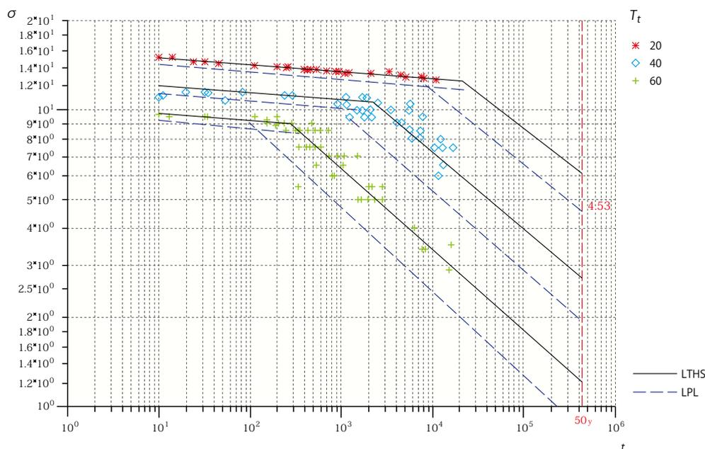
図-2 熱間内圧クリープ線図<sup>3)</sup>
