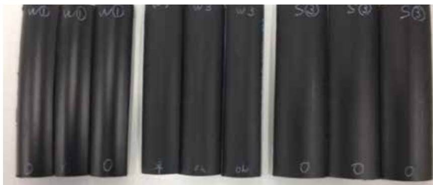
図-1 耐候性試験片(例)
