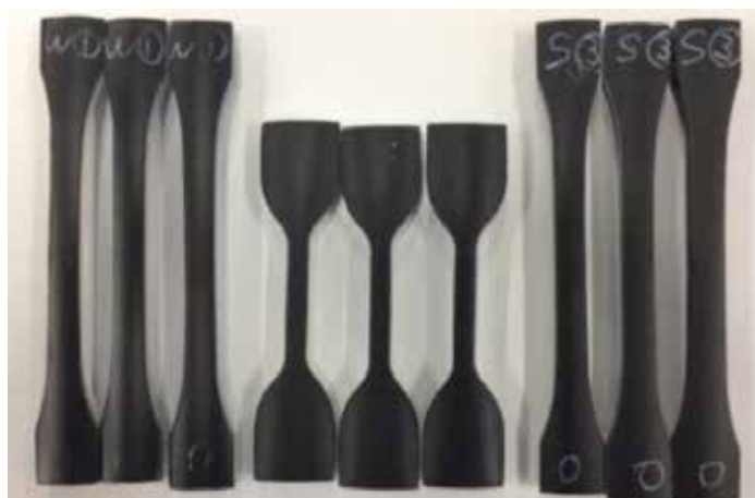
図－２ 引張試験片(例)
