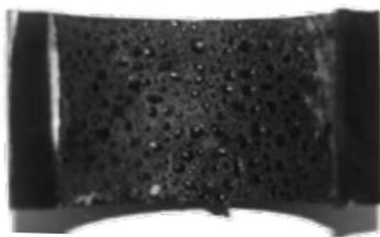
写真－1 単層管表面水泡剥離<sup>1)</sup>
